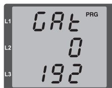
Fig. Gateway (GAT), Byte 0, value 192
